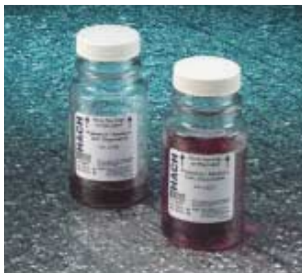
La prueba de P-A desechable aprobada de Hach es una herramienta de análisis efectiva.
